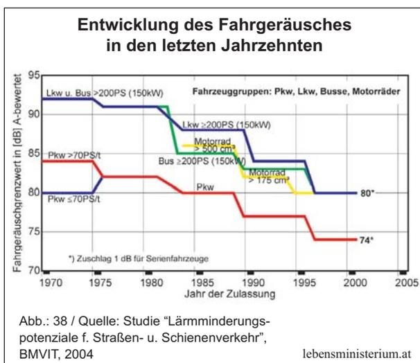
Für PKW gilt seit dem Jahr 1995/96 ein Lärmgrenzwert von 74 dB (A-bewertet). Die bisweilen erreichte Lärminderung am Antrieb des PKW wird allerdings durch die Zunahme von Anzahl und Streckenleistung und durch die Zunahme leistungsstarker und schwerer Fahrzeuge zum Teil egalisiert.
